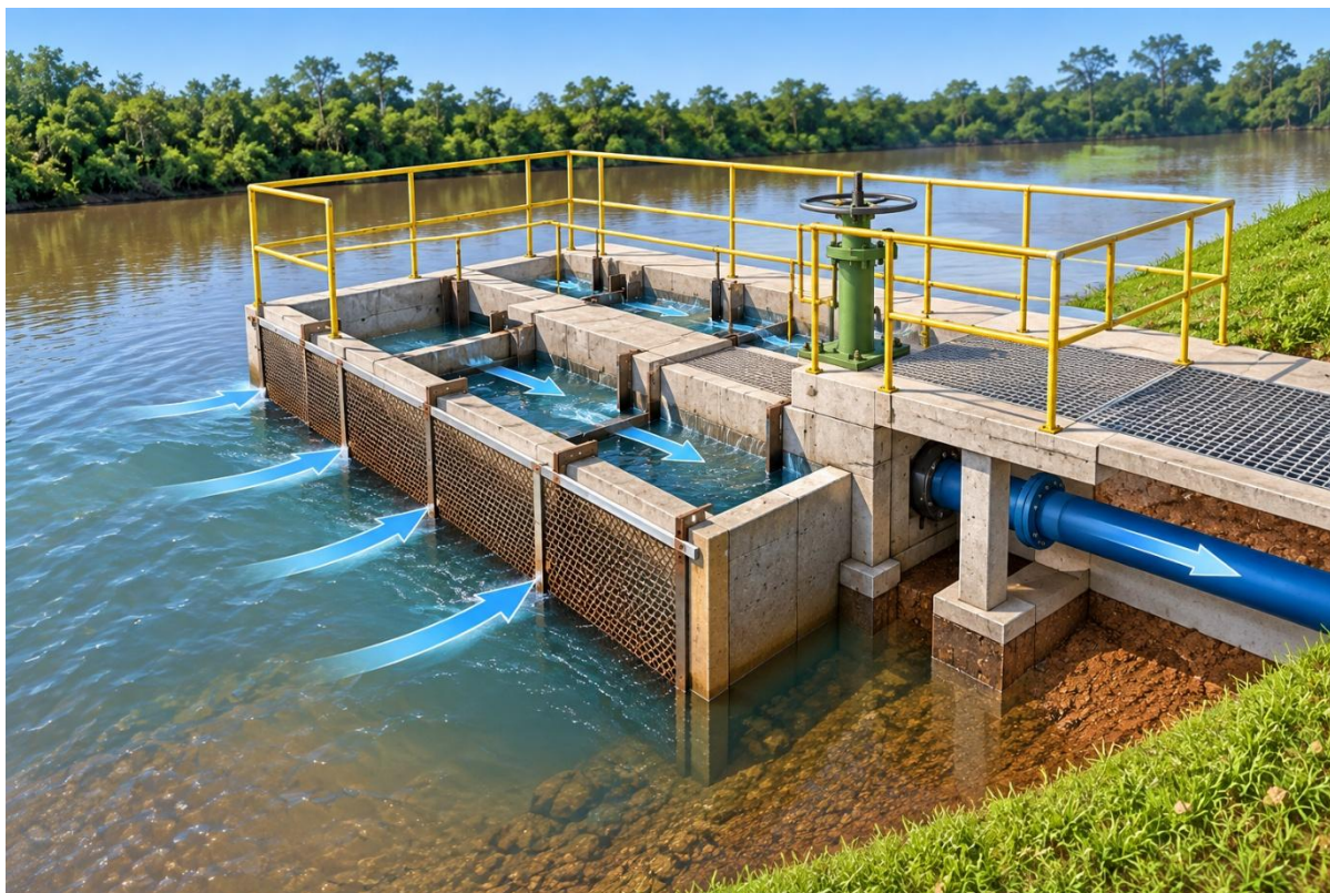
Figura 06 – Exemplo de sistema de captação superficial.
